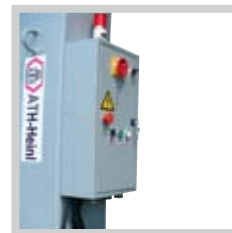
Schaltkasten Control box Armoire de commande
